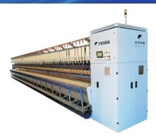
FX508A型湿纺细纱机是本公司为引导亚麻湿纺细纱机发展潮流,以FX505A为基础,从满足用户对高速、高 稳定性、高可靠性的要求出发,自主研发的新一代集电子牵伸、电子升降等技术于一体的智能型亚麻湿纺细纱机。
