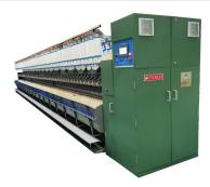
FX505A型湿纺细纱机系消化、吸收先进技术,处于国内领先水平的新机种。适用于纺制9.5公支-54公支的亚麻 细纱,还可用于苎麻、大麻的湿纺加工。机器自停罗拉运转和弹簧加压系统灵敏可靠。断头率低,牵伸罗拉获国家专 利。本机具有适纺范围广、纺纱支数高、转速高等特点。
