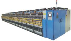
该机是在充分吸收国内外同类机型的优点基础上,结合用户的要求经不断改进而研制的亚麻粗纱机,系将前道并条工序提供的 麻条经梳理、牵伸、加捻后制成细度为1.2~4公支的均匀、优质的粗纱麻条,供细纱机纺制优质麻纱。适用于亚麻的纯纺及混纺。
